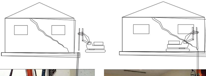
**Укрепление грунта «свайным методом»
